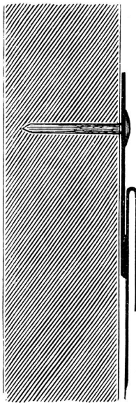
Natürliche Größe. Die oben an das Deckblech angelöthete, auf die Dachschalung genagelte Haften im Längsschnitt dargestellt.
