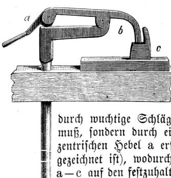
durch wuchtige Schläge des Hammers geschehen muß, sondern durch einen leichten Druck am exzentrischen Hebel a erfolgt (der hier geschlossen gezeichnet ist), wodurch die Pratz des Schenkels a-c auf den festzuhalrenden Gegenstand gedrückt wird. Die Pratz c ist mit einem Kugelgelenk versehen, so daß sich dieselbe auch schiefen Flächen des festzuhalrenden Gegenstandes anpassen kann und diese nicht be-
