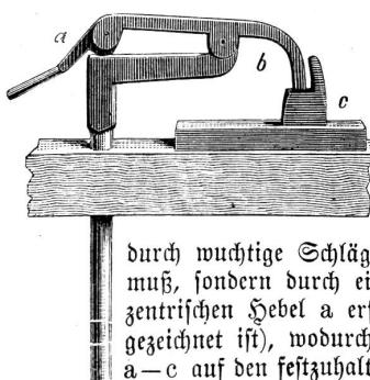
durch wuchtige Schläge des Hammers geschehen muß, sondern durch einen leichten Druck am exzentrischen Hebel a erfolgt (der hier geschlossen gezeichnet ist), wodurch die Pratz des Schenkels a - c auf den festzuhaltenden Gegenstand gedrückt wird. Die Pratz e ist mit einem Kugelgelenk versehen, so daß sich dieselbe auch schiefen Flächen des festzuhaltenden Gegenstandes anpassen kann und diese nicht be-
