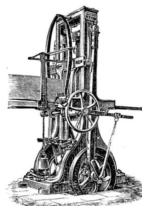
zeugt und die Maschine ohne wesentlichen Stoß arbeitet. Außerdem aber bewirkt die große Geschwindigkeit ein leichteres Freischneiden durch schnellere Entfernung der Sägespäne und ermöglicht auf die Weise auch einen feineren Schnitt unter geringerem Kraftverbrauch. — Der weitere wesentliche Vorzug dieser Maschine besteht in der Anwendung des Patent-Zuführungs-Apparates, welcher durch nachfolgende Eigenthümlichkeiten charakterisiert ist.
