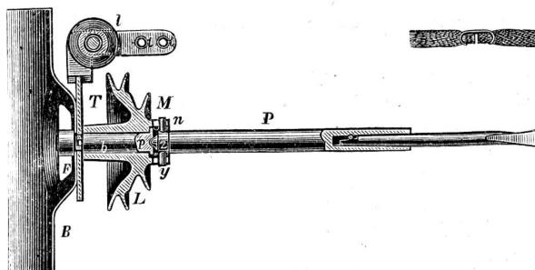
Die Art der Anwendung und die Zusammensetzung des Apparates ist in den beigefügten Abbildungen ersichtlich. Wie bereits zu Anfang erwähnt, besteht der Apparat aus zwei getrennten Theilen: der eigentlichen Bohrvorrichtung und dem Antriebsgestell. Die Bohrvorrichtung ist hier oben abgebildet und besteht in der Hauptsache aus dem Brustblech B, dem doppelten Schnurlauf L, dem Leitrollenhalter T und der Bohrspindel P.
