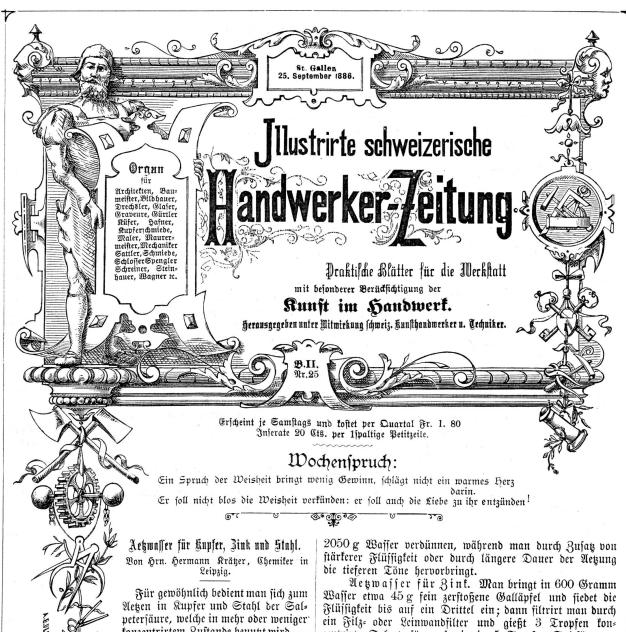
Ant gewohntel vertein mehr feld gim Aupfer und Stahl der Salspeterfäure, welche in mehr oder weniger fonzentrirtem Zustande benutzt wird. — Die Anwendung dieser Säure hat jedoch den mißlichen Umstand, daß sie auf dem betreffenden Metall Gasblasen hervorrust, wodurch die Aetzung nicht
