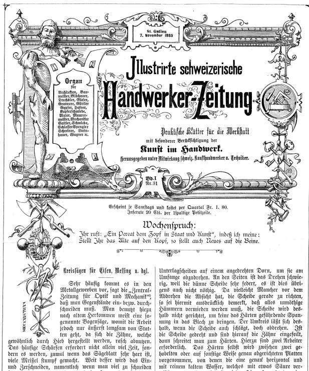
frumm werden oder auch reißen - man mag fie in Baffer, Talg 2c. harten — so wollen wir im Folgenden einige Rathschläge ertheilen, wie man am besten bei ber Herstellung dieser Sägen zu verfahren hat. Aus gutem Stahlblech von zirka 1 Millimeter Dicke haut ober dreht man Scheiben von ungefähr 100 bis 120 Millimeter Durchmeffer aus, bohrt ein Loch von 15 Mm. und befestigt diese Scheibe mittelft Mutter zwischen zwei
