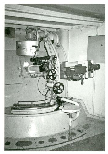
Zu der Bestückung des Bunkers «Stoss-Süd» gehört neben Maschinengewehren die Panzerabwehrkanone mit dem Kaliber von 9 cm. Sie schiesst äusserst präzise und wäre dank ihrer sehr hohen Durchschlagskraft auch für moderne Panzer ein ernst zu nehmender Gegner.
