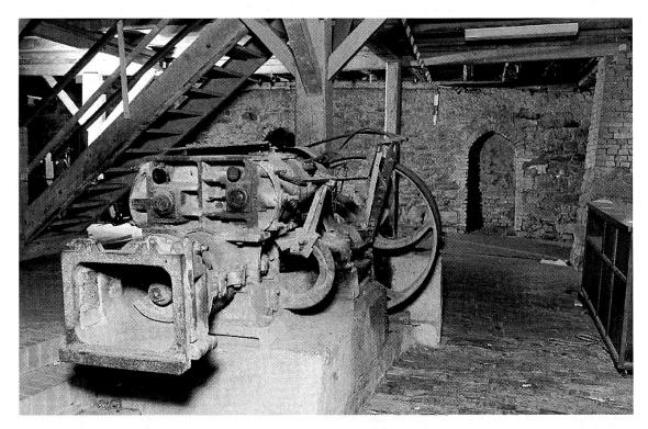
Maschine zur Herstellung von Drainagerohre. Im Hintergrund eine der acht Zugangsöffnungen zum Ringofen (Foto M. Hutter).
