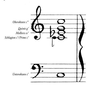
Abb. 5: Tonaufbau einer modernen c'-Glocke (Molloktavglocke).
