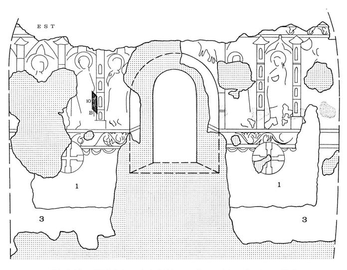
Abb. 4: Marc Stähli, Schematische Zeichnung, Ostwand der reformierten Kirche Obstalden, 1979. Ziffern 1 und 3: Chronologie der verwendeten Mörtel; gepunktete Flächen: Fehlstellen mit abgefallenem Mörtel oder Löcher.
