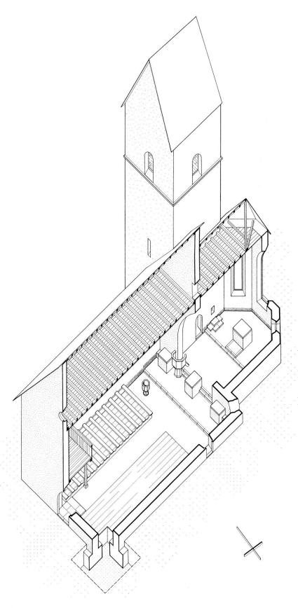
Abb.11: Rekonstruktion der spätgotischen Kirche. Das niedrigere Dach über dem Chor wurde in Anlehnung an die Kirche von Elm gewählt. (Zeichnung: F.J. Wadsack)
