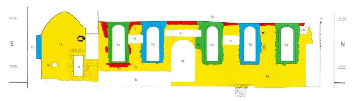
Tafel 2: Längsschnitt mit Ansicht der Westmauer des Schiffes. M. 1:200.
