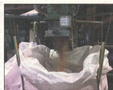
Erster Schritt zu neuen Korken: Herstellung von Granulat.
