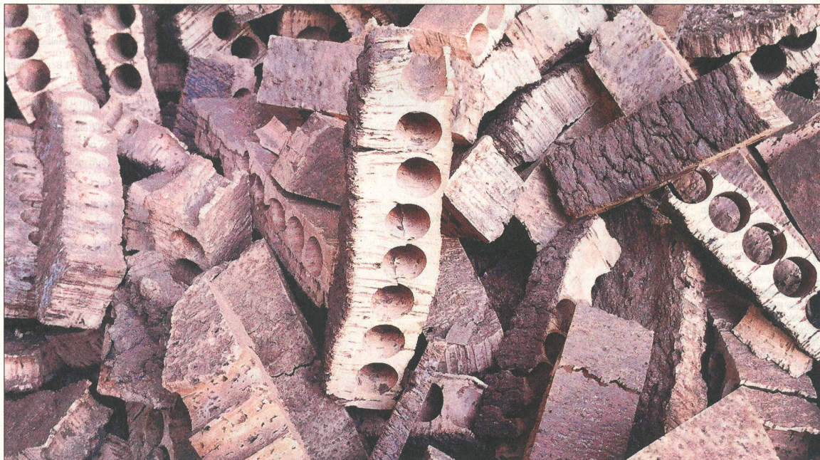
Die Basis der rekonstruierten Zapfen ist Granulat. Der geschmacksfreie Kork wird auch aus Resten der Naturkorkenproduktion hergestellt.
