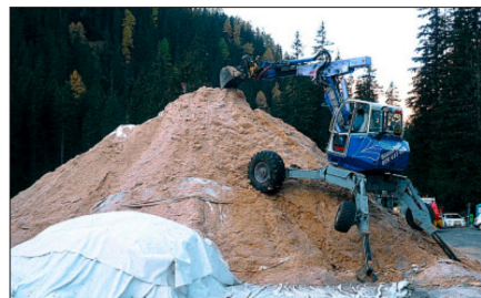
Die 40 cm dicke Sägemehl-Schicht hat den Schnee besser vor dem Abschmelzen geschützt als das Gletschervlies (vorne).
