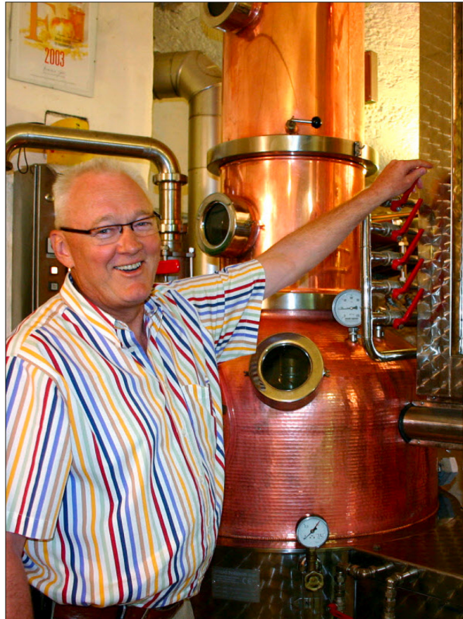
Georg W. Schenk mit dem Herzstück seiner Brennerei – der Brennblase aus Kupfer und Edelstahl.
