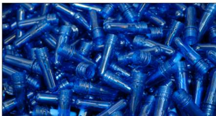
Diese Rohlinge werden maschinell zu PET-Flaschen aufgeblasen.
