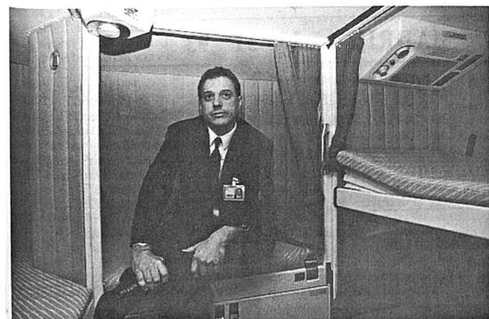
Der neue Airbus A340-200 der Lufthansa ist mit einem Abteil mit sechs Liegen für die Eratzcrew ausgerüstet. *Bild Pierre Vivot*
