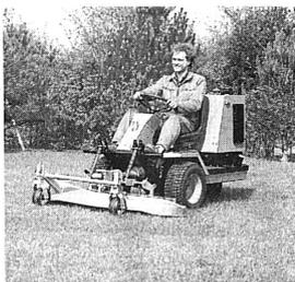
Extreme Wendigkeit erlaubt hochproduktives Arbeiten, auch unter schwierigen Einsatzbedingungen. Der hydrostatische Fahrtrieb macht kein Kuppeln und kein Schalten mehr nötig. Alle Bedienelemente befinden sich in unmittelbarem Griffbereich des Fahrers. Der wirtschaftliche 16-PS-Zweizylinder-Dieselmotor ermöglicht grössere Arbeitsbreiten und höhere Arbeitsgeschwindigkeiten als handgeführte Maschinen.
