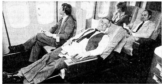
Mit diesen neuen Senator-Sleeper-Sitzen der Firma Weber werden Anfang 1982 die Erste-Klasse-Abteile aller Lufthansa-Langstreckenflugzeuge vom Typ Boeing 747 und DC-10 ausgestattet. Die Umrüstung wird im Mai abgeschlossen sein.
