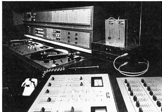
Einschubtechnik, die Lösung von heute für morgen. Diese Einschübe können, ohne dass eine Schraube gelöst wird, ausgewechselt werden. Klare und eindeutige Funktions- oder Nichtfunktionsanzeigen ermöglichen den Austausch der Einheit auch durch Nichtfachleute. (Werkfoto Mülke, Kloten)
