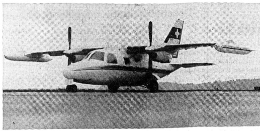
Japaner am Schweizer Himmel. Die Bedarfsflüge von Lugano nach Zürich oder Genf werden mit einer Maschine vom Typ Mitsubishi MU-2 durchgeführt. Die MU-2 bietet 6 bis 7 Passagieren Platz und ist besonders für den Einsatz auf kleinen Gras- oder Harbelagelflächen geeignet, da die Startstrecke nur 550 m, die Landstrecke sogar nur 485 m beträgt. Das Flugzeug hat eine maximale Reichweite von 2700 km. Es erreicht eine mittlere Reisegeschwindigkeit von 560 km/h (Höchstgeschwindigkeit 590 km/h), hat einen geringen Lärmpegel und fliegt in Flughöhen von bis zu 9500 Metern.
