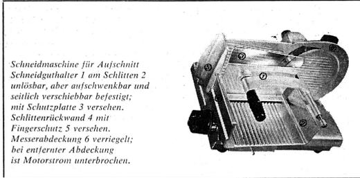
Schneidmaschine für Aufschnitt
