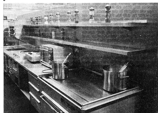
6 Elektronik-Herd mit stufenloser Wärmeregulierung. Die Kochplatte ist in verschiedene Wärmefelder aufgeteilt.
