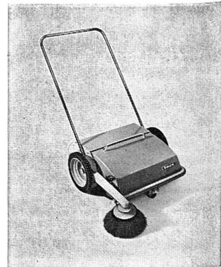
Die Firma H. A. Ziegler, 8600 Dübendorf, vertreibt die japanische Kehrmaschine «Swick Mark II», die ohne Motor, geräuschlos und rationell Staub, Sand, Steine, Zigarettenstummeln, Papier usw. aufnimmt. Zwei gegenläufig rotierende Bürsten und eine Seitenbürste werden beim Schieben des Geräts in Bewegung gesetzt. Pro Stunde können über 700 m<sup>2</sup> Bodenfläche gereinigt werden.
