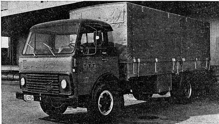
Le camion ci-dessus a toutes les particularités qui caractérisent les grands camions Volvo, prévus pour 5 tonnes de charge utile. Moteur, boîte de vitesses, pont arrière et châssis sont conçus pour des transports rapides de tous genres, une charge utile maximum et la plus grande longévité.
