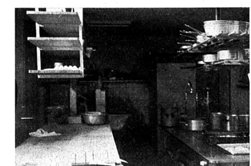
Die Küche. Man beachte die aufgehängten Tablare über dem Arbeitstisch – den Rest über dem Herd, den breiten Herdrand, im Hintergrund links die Gemüseinsel und die Platte, rechts die Kühlschränke, quergestellt mit Zweiseitenschrank als Bewegungsfäche. Die Rückseite des Kühlschranks ersetzt die Wand!
