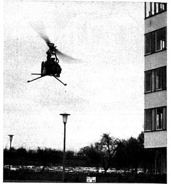
und 1,01 m Höhe ideal verpackt werden. Das Flugzeug selbst hat einen Rotordurchmesser von 7,5 m, die Länge des Rumpfs beträgt 3,2 m, Breite des Landgestells 2,06 m und die Höhe 1,89 m. Tit
