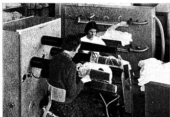
Automatische Kontrolle von rohen Nahtlos-Strümpfen
