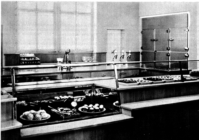
10 Ausgabekörper in einer grossen Kantine mit Verkaufsvitrine und im zweiten Korpus Fruchtsaftabgabe, sowie 6 Kühlschrank-abteile rechts
