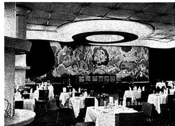
Grosser Speisesaal. Die 7 Pfeiler des Raumes sind in 2 m Höhe mit Vouten versehen, von denen aus Reflektorlampen die Saaldecke ziemlich gleichmässig ausleuchten. An den Wänden laufen Vouten um, die die Allgemeinbeleuchtung besorgen.
