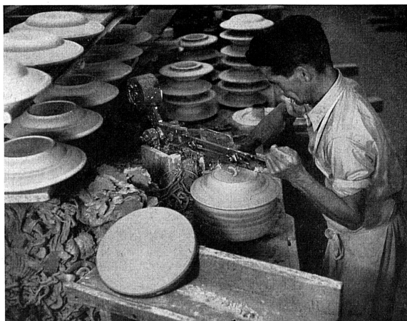
Der Teller ist fertig überformt, die Schablone wird abgehoben, der vorläufig noch auf der Gipsform verbleibende Teller geht weiter zum Trocknen.
