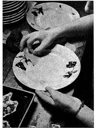
Un des procédés de décoration les plus simples est la décalcomanie, c'est-à-dire l'application sur l'objet d'un décalque coloré, reproduit à l'aide de pierres lithographiques.
