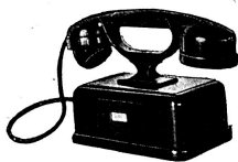
Hotelapparat der eidgen. Telephonverwaltung für Verwendung in Gastzimmern gegen einen jährlichen Abonnementpreis von Fr. 8.—. Das Abheben des Hörers stellt die Verbindung mit der Hauszentrale her.
