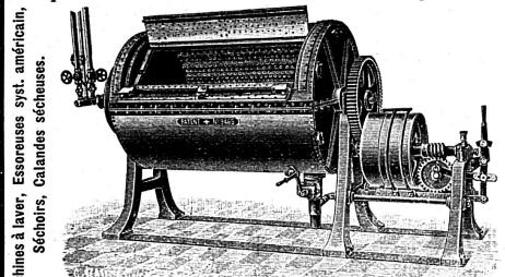
Machines à laver, Essoreuses syst. américaines, Séchoirs, Calandres sécheuses, Désinfection, Essorage, Coulage, Lavage, Rinçage, Azurage sans changer de machine.
