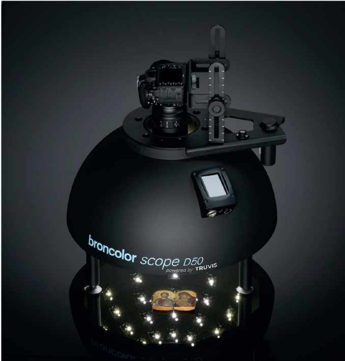
Abb. 2. Ein am DHLab entwickelter Lichtdom zur Aufnahme von RTI Aufnahmen. Quelle: DHLab.
