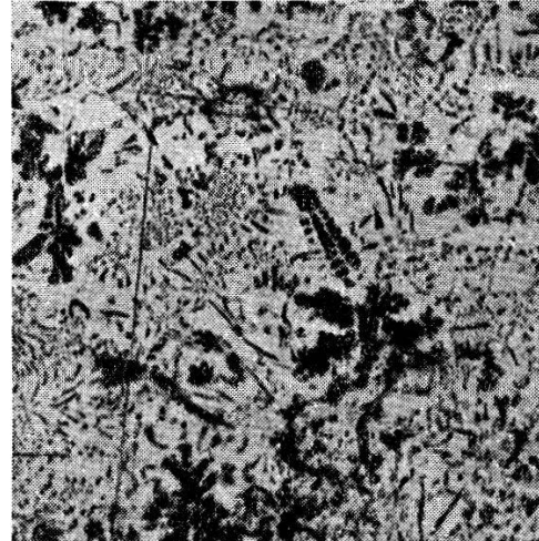
Fig. 1d. 74,1 Atomproz. Mn – 25,9 Atom- proz. Sb. 70fache Vergrößerung, geätzt mit verdünnter \text{HNO}_3 .
