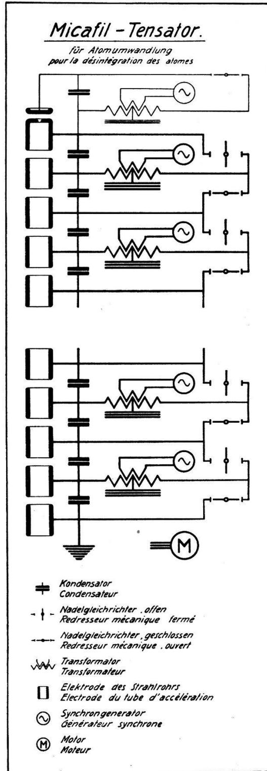
Fig. 1. Schaltschema zum Gleichspannungs-Generator.
