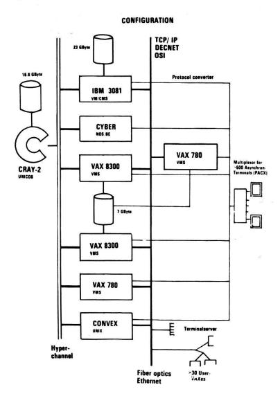
Abb. 8: Das Netz des Rechenzentrums der Universität Stuttgart
