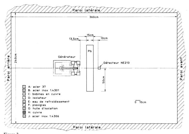
Figure 3 Schéma de l'arrangement expérimental avec le générateur (tube-source), une plaque de plomb (Pb) et le spectromètre NE213.
