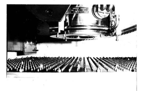
Figure 2 Tube-source de neutrons et module LBM.
