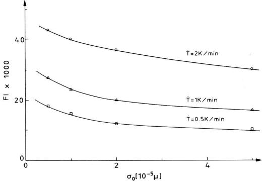
Figure 9 Co: dépendance du maximum de FI en fonction de la contrainte  $\sigma_0$ , f = 1 Hz.
