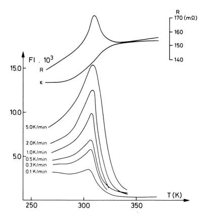
Figure 6 FI, résistance électrique R et changement de forme  $\varepsilon$  (torsion) d'un échantillon de TiNi en fonction de la température pour différentes vitesses de refroidissement (amplitude de vibration  $\approx 2 \times 10^{-6}$ ), d'après Zhu Jing Song [8].
