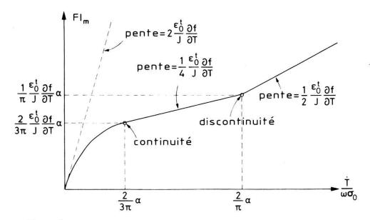
Figure 3 Dépendance du FI en fonction de  $\dot{T}/\omega\sigma_0$  telle que prévu par le modèle.
