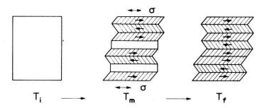
Figure 1b Schéma montrant l'apparition des variantes au cours de la transformation de phase (modèle à deux variantes).  $T_i$ : début de la transformation,  $T_f$ : fin de la transformation,  $T_m$ : vitesse maximale de transformation.
