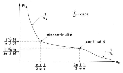
Figure 4 Dépendance du FI en fonction de l'amplitude de la contrainte appliquée  $\sigma_0$  telle que prévu par le modèle  $(\dot{T}/\omega \text{ constant})$ .
