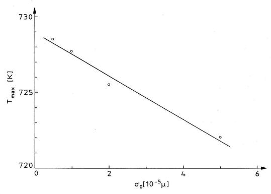
Figure 10 Co: dépendance de la température du maximum de FI en fonction de la contrainte  $\sigma_0$ ,  $\dot{T} = 0.5 \text{ K/Min}$ , f = 1 Hz.
