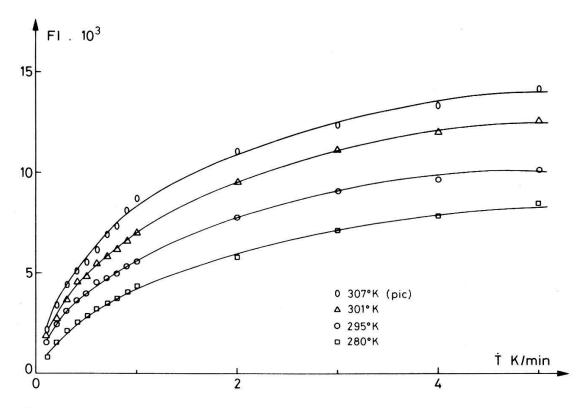
Figure 7 TiNi: FI en fonction de la vitesse de refroidissement  $\dot{T}$  pour différentes températures (amplitude de vibration  $\cong 2 \times 10^{-6}$ , f = 0.47 Hz), d'après Zhu Jin Song.
