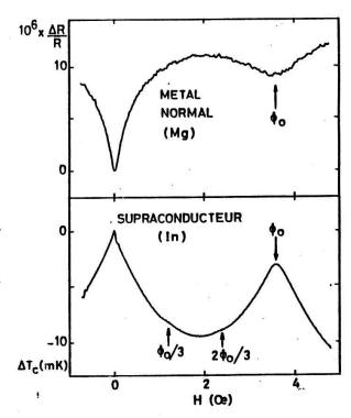
Fig. 7: Comparaison entre les oscillations de magnétorésistance d'un métal normal (en haut) et de  $T_c$  d'un métal supraconducteur (en bas). La période est la même dans les 2 cas  $\phi$  = hc/2e.
