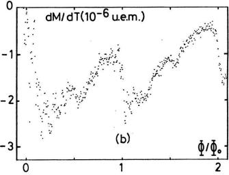
Fig. 5: a) Dérivée du bord du spectre de la Fig. 3. Noter que cette dérivée présente une discontinuité pour chaque valeur rationnelle de  $\phi/\phi_o$ . b) Dérivée de l'aimantation dM/dT d'un réseau carré d'indium (Ref. 6).
