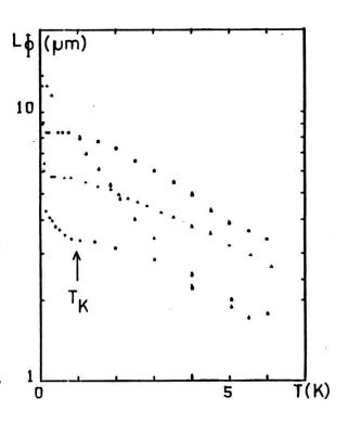
Fig. 9: Longueur de diffusion inélastique mesurée pour Mg, Au et Cu. L<sub>\phi</sub> représente la longueur sur laquelle la cohérence de phase est maintenue : 13 µm dans Mg.
