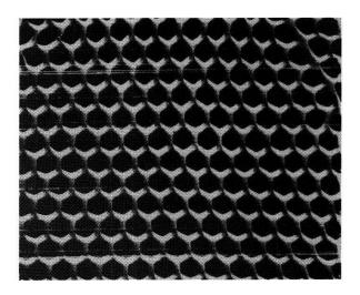
Fig. 1 : Partie d'un réseau en nid d'abeille d'or. Le diamètre intérieur des cellules est de 2  $\mu$ m. Le réseau contient  $3.10^6$  cellules.
