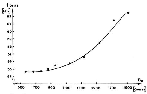
Figur 2.9 Gemessene Driftfrequenz in Funktion des äusseren Magnetfeldes  $B_0$ .
