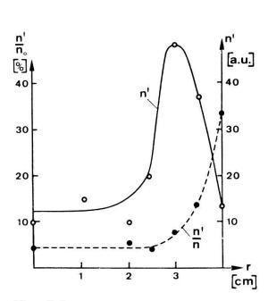
Figur 2.4 Gemessene Amplitude der Fluktuationen n' und Fluktuationsgrad n'/n in Funktion des Radius.
