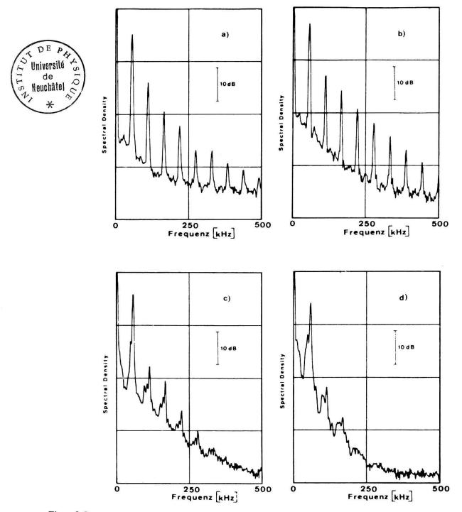
Figur 2.8 Spektrum der Dichtefluktuationen in Funktion des äusseren Magnetfeldes  $B_0$ . Willkürliche Einheiten. a)  $B_0 = 580 \,\text{G}$ , b)  $B_0 = 770 \,\text{G}$ , c)  $B_0 = 960 \,\text{G}$ , d)  $B_0 = 1150 \,\text{G}$ , e)  $B_0 = 1350 \,\text{G}$ , f)  $B_0 = 1540 \,\text{G}$ , g)  $B_0 = 1730 \,\text{G}$ , h)  $B_0 = 1920 \,\text{G}$ .
