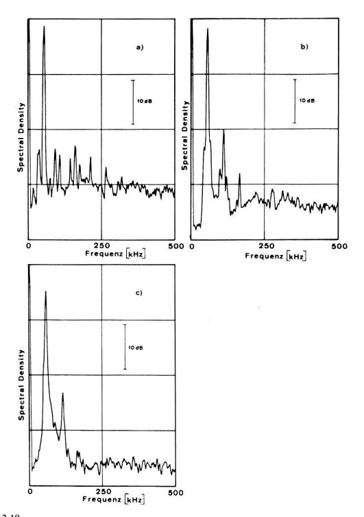
Figur 2.10 Spektrum der  $B_0$ -Komponente der Magnetfeldfluktuationen in Funktion des äusseren Magnetfeldes. Willkürliche Einheiten. a)  $B_0 = 770 \,\text{G}$ , b)  $B_0 = 1030 \,\text{G}$ , c)  $B_0 = 1540 \,\text{G}$ .
