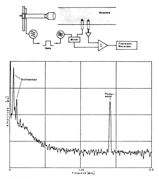
Figur 2.11 Messanordnung zum Nachweis des parametrischen Zerfalls, Frequenzspektrum.
