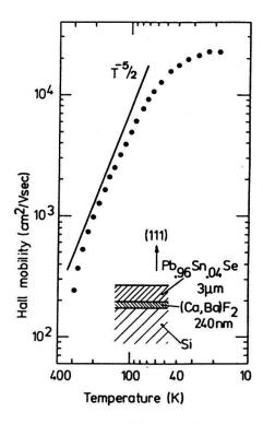
Fig.1: Hallbeweglichkeit von epitaktischem n-PbTe (n=2.6·10 cm<sup>-3</sup>) auf (Ca,Ba)F<sub>2</sub>/Si
