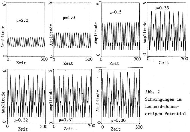
und die Genauigkeit pro Schrittweite betrug  $10^{-4}$ . Den Antrieb haben wir auf f=0.5,  $\omega=1/\sqrt{8}\approx0.35$  festgesetzt. Abhängig vom Parameterwert der Dämpfung  $\mu$  erhält man die Datensätze x(t) (Abb. 2).
