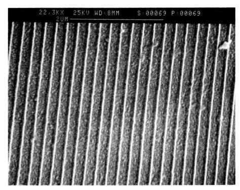
Fig. 2 Réseau holographique gravé dans un substrat de GaAs, le pas est de  $0,25~\mu m$ . Notez la régularité des franges.
