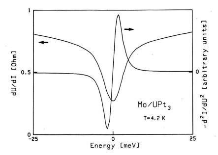
Fig. 1: Differentieller Widerstand dU/dI und 2. Ableitung d<sup>2</sup>I/dU<sup>2</sup> eines Mo-UPt<sub>3</sub>
