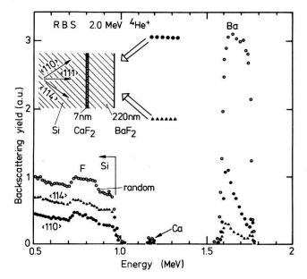
Fig. 1 RBS Spektren bei zufälliger und <111>-Orientierung
