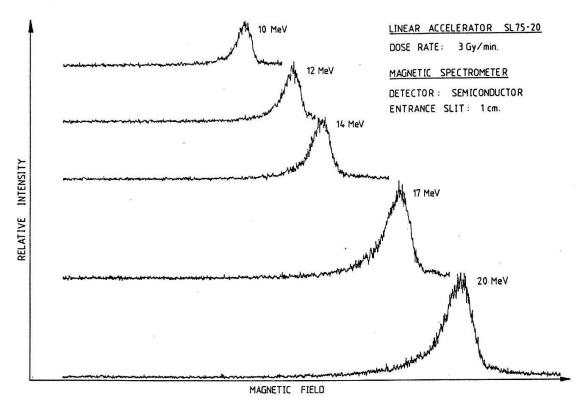
Figur 1: Energiespektren gemessen am Linearbeschleuniger SL75-20. Das Bestrahlungsfeld war 5 x 7 cm $^2$  gross.
