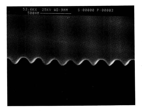
Fig. 3 Réseau holographique de pas 0,25 µm dans du GaAs. Notez le contraste élevé du réseau.
