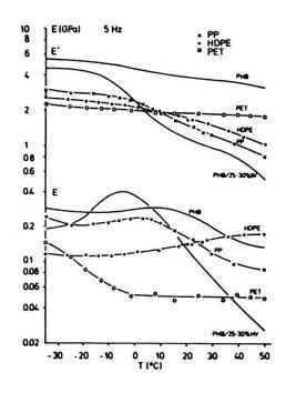
Bei einer Frequenz von 5 Hz wurde PHB/HV im Vergleich mit PE, PP und PET untersucht. Der E-Modul von PHB ist bei Raumtemperatur relativ hoch (ca. 4 GPa), die Schlagzähigkeit jedoch niedrig (1). PHB/HV-Copolymere erweisen sich als schlagzäher und weniger temperaturstabil hinsichtlich des E-Moduls (2).
