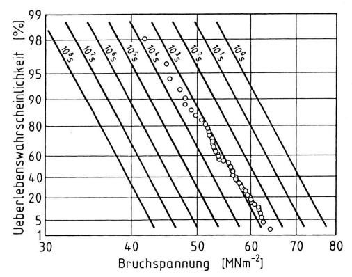
Abb.2: SPT-Diagramm (——) berechnet aus KZV-Messungen.
