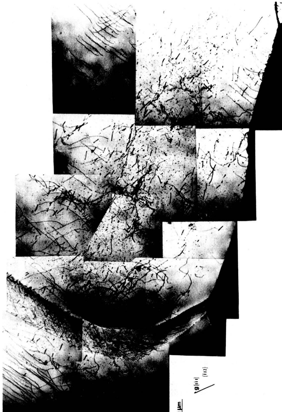
Figure 8 Débris après fluage d'un polycristal d'Al-Zn. Mêmes conditions que Fig. 7. \epsilon = 15\% . Dislocations ancrées sous charge. D'après [18].
