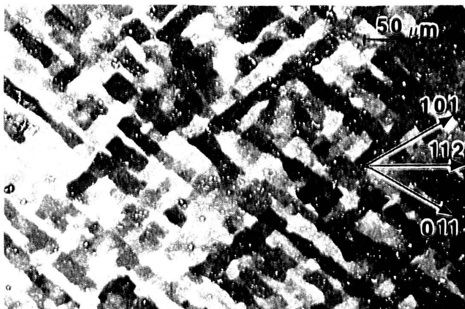
Figure 5 Sous-grains de fluage. Monocristal d'aluminium d'axe 112. Section (\bar{1}\bar{1}1) , 150^\circ\text{C} , 19,6 \text{ MPa} , \varepsilon = 20\% . Microscope à balayage. Electrons rétrodiffusés. D'après [14].
