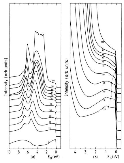
Figur 5 UPS Valenzbandspektren von abschreckend kondensierten  $\operatorname{Au_xSn_{100-x}}$  Filmen. Die Proben mit einem Au-Gehalt zwischen 20 and 70 at% weisen eine amorphe Struktur auf. a) Uebersicht über den ganzen Bereich des Valenzbandes, b) Verlauf direkt unterhalb  $E_{\rm F}$ .
