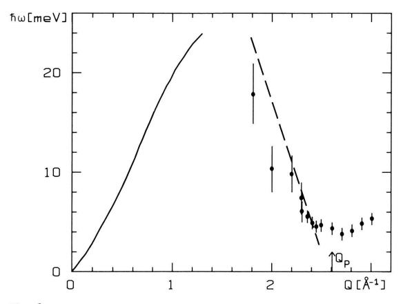
Figur 2 Gemessene Dispersion der kollektiven Dichtefluktuationen in der Umgebung von  $Q_p$ . Ausgezogene Kurve: Transversaler Dispersionsast nach Modellrechnung [4]; gestrichelte Kurve: theoretischer Verlauf in Folge diffuser 'Umklapp-Prozesse' [9].
