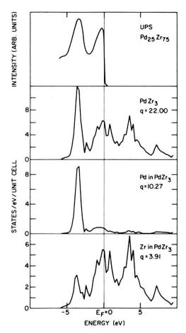
Figur 3 UPS Valenzbandspektrum gemessen mit He I (21,22 eV) Anregung am metallischen Glas  $Pd_{25}Zr_{75}$  (oberste Kurve) und berechnete totale und lokale Zustandsdichten.
