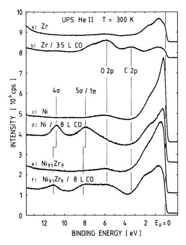
Figur 7 UPS Valenzbandspektren gemessen mit He II (40,8 eV) Anregung an polykristallinem Zr und Ni, sowie am metallischen Glas  $Ni_{91}Zr_{9}$  vor und nach der Adsorption von CO.
