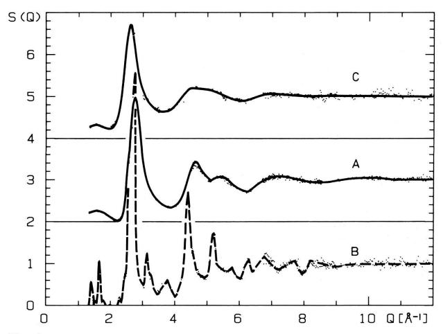
Figur 1 Totaler Strukturfaktor S(Q) von glasartigem (Kurve A), polykristallinem (Kurve B) und flüssigem  $Mg_{70}Zn_{30}$  (Kurve C, T = 400°C).
