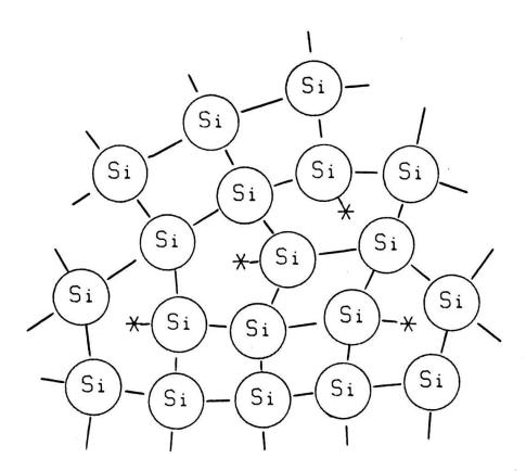
Fig. 1: Description schématique d'un réseau de silicium amorphe. La déformation par rapport au cristal parfait produit des liaisons non satisfaites (marquées \*). En présence d'hydrogène atomique produit, par exemple, dans la décomposition du silane SiH4 dans un plasma, cet hydrogène se place sur les liaisons "cassées" et ainsi toutes les liaisons dans le matériau sont satisfaites.
