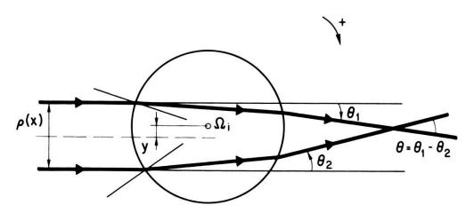
Figure 4 Angle d'ouverture du faisceau après la traversée d'une bulle.
