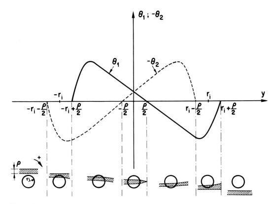
Figure 5 Variation de l'angle de déviation des deux génératrices extrèmes en fonction de y – position relative correspondante de la bulle par rapport au faisceau laser (zone hachurée).
