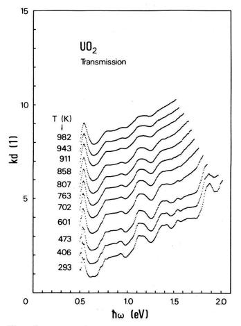
Figur 1 Optische Dichte Kd von  $UO_2$  bei 11 verschiedenen Temperaturen. (Probendicke  $d = 52 \pm 2 \mu m$ ). Die Reflexionsverluste sind auskorrigiert. Aufeinanderfolgende Kurven oberhalb 293 K sind um 0.5 Einheiten verschoben.
