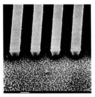
Figur 1 Struktur Ti auf Quarz mit  $4.8~\mu m$  Periode und  $2.4~\mu m$  Tiefe.
