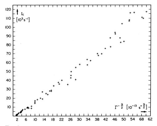
Lineare Abhängigkeit der gestreuten Intensität von  $\Gamma^{-9/2}$  wobei  $\Gamma$  die Linienbreite des gestreuten Lichtes ist.
