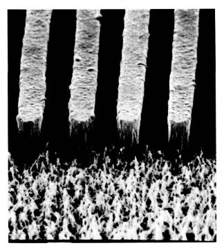
Figur 2 Struktur Ti auf Quarz mit 4.8  $\mu$ m Periode und 6  $\mu$ m Tiefe.
