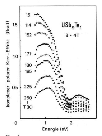
Figur 1 Polare Kerr-Rotation einer  $USb_{0.9}Te_{0.1}$ -Spaltfläche für acht verschiedene Temperaturen unter- und oberhalb der Ordnungtemperatur  $T_N$ =207 K bei einem äusseren Magnetfeld von 4 T.
