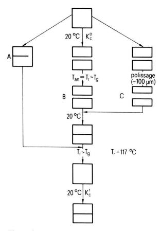
Figure 1 Principe de la méthode de cicatrisation et de la préparation des échantillons.
