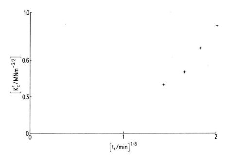
Figure 3 Variation du facteur d'intensité des contraintes  $K_c^r$  des échantillons cicatrisés de type A (surfaces fibrillaires), en fonction de  $t_r^{1/8}$ .
