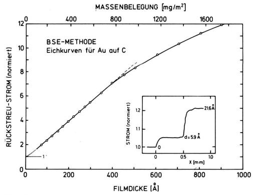
Figur 2 Abhängigkeit des Rückstreustromes von Massenbelegung bzw. Filmdicke.
