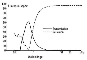
Figur 1 Spektrale Eigenschaften eines 4 mm dicken Glases 'Eliotherm Saphir'. Die dargestellte Reflexion entspricht der Reflexion der beschichteten Oberfläche.
