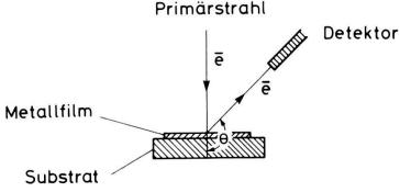
Figur 1 Prinzip der Bestimmung der Massenbelegung durch Rückstreuelektronen.
