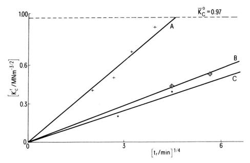
Figure 2 Variation du facteur d'intensité des contraintes  $K_c^r$  des échantillons cicatrisés en fonction du temps cicatrisation  $t_c^{1/4}$  pour: A: surfaces fibrillaires, B: surfaces traitées thermiquement, C: surfaces polies.
