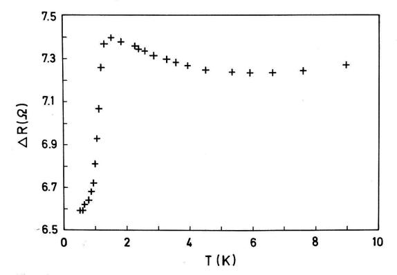
Figur 4 Beobachtete elektrische Widerstandsänderung mit der Temperatur entlang der a-Achse von  $(TMTSF)_2ClO_4$ . (Für T < 0.5 K existieren neben der supraleitenden Phase auch serielle resistive Bereiche, die durch Mikrocracks in den Ketten beim Abkühlen entstanden sind. Dies erklärt den vermeintlichen Restwiderstand von  $6.6\,\Omega$ .)
