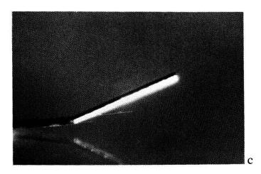
Figur 1a-c Demonstration der Möglichkeit des reversiblen Verschiebens der Zwillingsebene eines Zwillingskristalls durch radiale Kräfte (s. Text).
