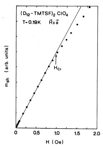
Figur 7 Magnetisierungskurve von  $(TMTSF)_2ClO_4$  entlang der a-Achse. Das erste Eindringen von Flußquanten bei  $H_{c1}^a$  ist durch einen Pfeil markiert.
