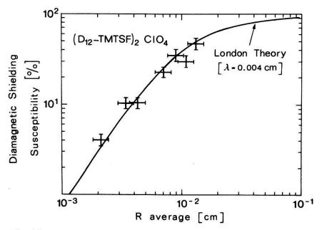
Fig. 10 Beobachtete Reduktion der diamagnetischen Suszeptibilität in dünnen Proben infolge der makroskopisch großen London'schen Eindringtiefe (Feldrichtung = a-Richtung, r = mittlerer Radius der Proben in der  $b^*/c^*$ -Ebene).
