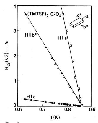
Figur 5 Messung von  $H_{c2}$  in den drei Hauptachsenrichtungen (Greene et al. [8]).
