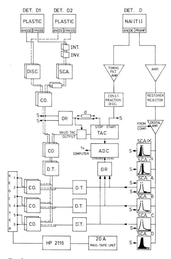
Figure 5 Schéma du système électronique. SCA: analysateur à 1 canal; S: échelle de comptage; D.T.: discriminateur lent avec délai et largeur réglable de l'impulsion de sortie; d = délai pour l'étalonnage en temps du TAC.
