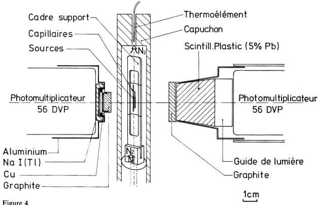
Disposition de la source et des détecteurs.
