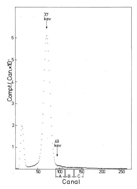
Figure 3 Spectre d'énergie d'une source de <sup>80</sup>Br<sup>m</sup> mesuré dans le détecteur NaI (T1). Les fenêtres d'énergie utilisées dans la mesure sont indiquées par A, B et C.
